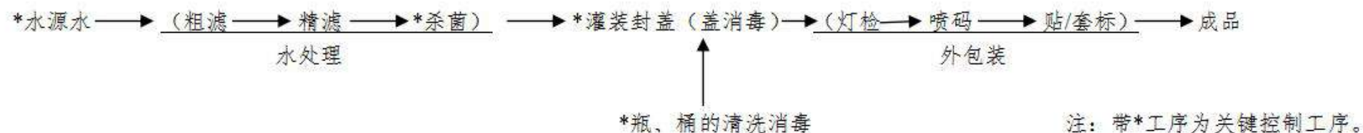
图 1-1 桶装、瓶装生产工艺流程图
